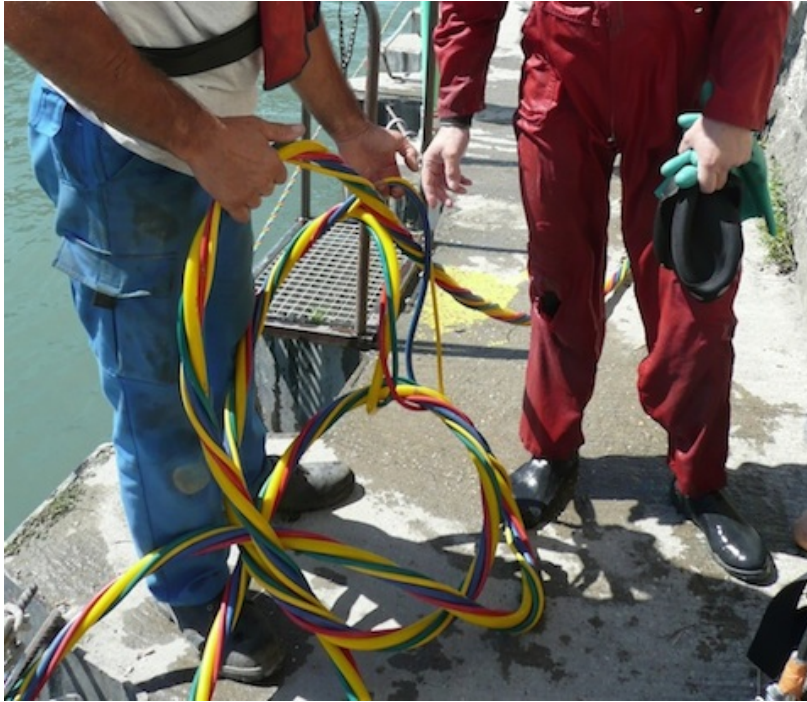
Entre tendeur et plongeur : un narguilé noué (Chantier, Août 2011). Photo Céline Rosselin.
