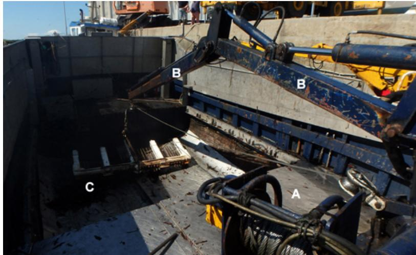
*Figure 5 : Le bras hydraulique et le peigne. Au premier plan, nous apercevons le treuil avec le câble (A). Au-dessus, le bras hydraulique et ses vérins (B) qui permettent ses mouvements et le peigne (en blanc) (C) dans le fond de la cale. C. Garineaud 2014.*
